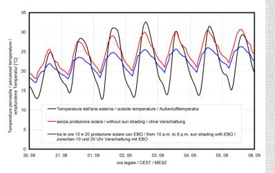
Nel grafico è stato simulata la variazione della temperatura interna di un ambiente al variare della temperatura esterna con e senza l'utilizzo di **Euro Blackout** come una protezione solare.
